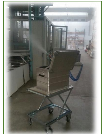
Dispositivo per la produzione di aerosol mediante collisione flusso liquido-liquido.
